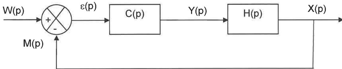
**Q17** - Déterminer l'expression de la fonction de transfert en boucle fermée  $F(p) = \frac{X(p)}{W(p)}$  en fonction de  $C(p)$  et de  $H(p)$ .
